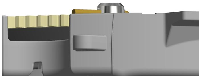
Para verificar, mantenha o disco nivelado contra a placa da unidade central. O número de calços necessários é determinado pelo acréscimo ou remoção dos calços do disco entre os planos inferior e superior. O disco do medidor precisa ser verificado em pelo menos duas posições para determinar a contagem final dos calços. Gire **180°** para verificar.
